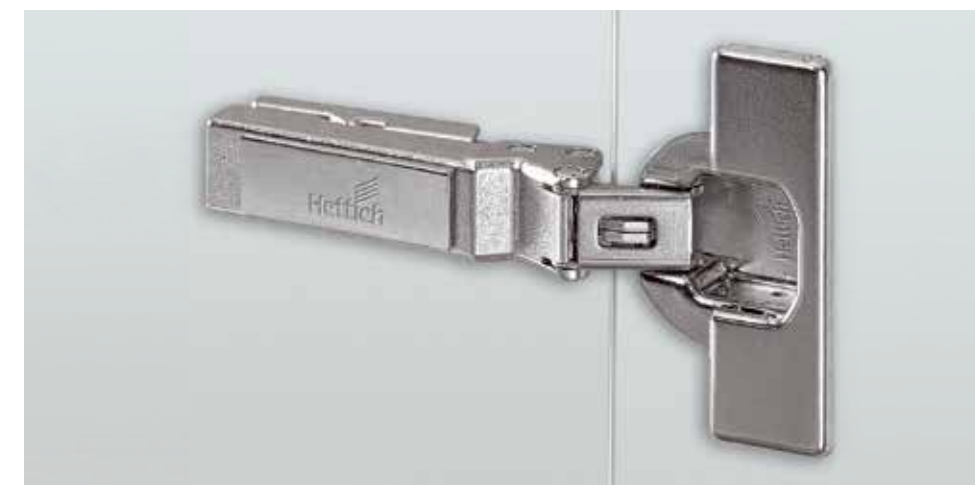
W-30 накладная петля (угол открывания 125°, угол корпуса -30°) W-30 full overlay negative angle hinge (opening angle 125°, for -30° face angle) W-30 Negativ-Winkelscharnier voll vorliegend (Öffnungswinkel 125°, für Korpuswinkel -30°)
