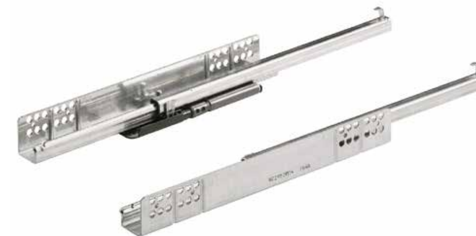
Номинальная длина 250, 300, 350, 400, 450, 500мм Направляющие частичного выдвижения Встроенный демпфер Silent System Нагрузочная способность 25кг
