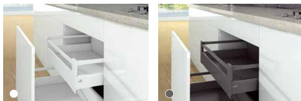
Внутренняя система выдвижения с релингом, высота задней стенки 186мм Номинальная длина направляющих 300, 500мм Высота боковины 94мм
