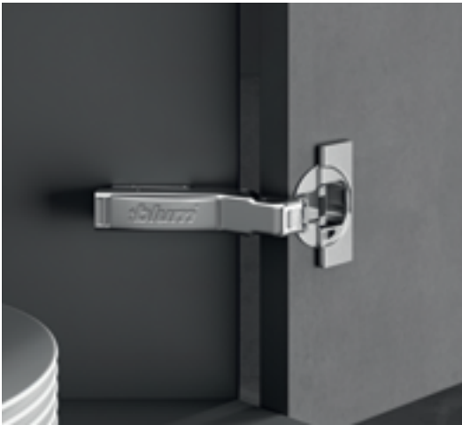
RU Петля угловая W45 Навеска двери: полунакладная Угол открывания 95°, угол корпуса 45° EN Angle hinge W45 Door mounting: dual Opening angle 95°, face angle 45° DE Winkelscharnier W45 Anschlagart: Mittelschlag Öffnungswinkel 95°, Korpuswinkel 45°
